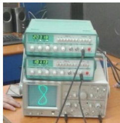
Montaj experimental-semnale de frecvențe aflate în raport de \frac{1}{2} .
